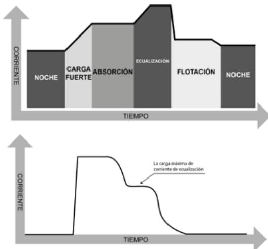
Si el regulador solar está trabajando en la etapa de flotación pero, en ese momento, el intervalo de ajuste de la equalización (el ciclo de equalización de las baterías) ha llegado, se transferirá a la etapa de equalización.
