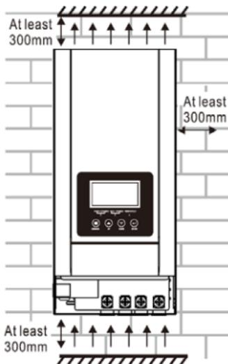
Instale la unidad en una pared mediante dos tornillos:
