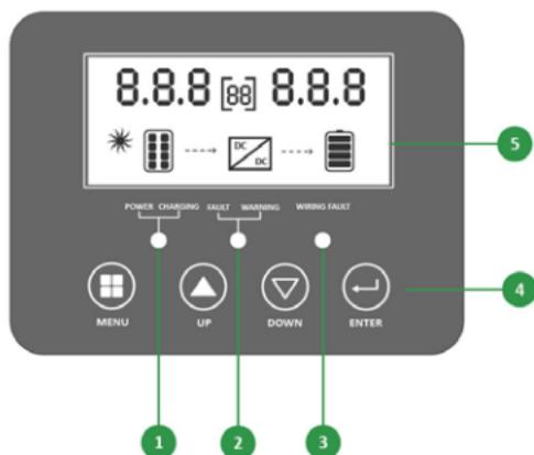
1. Indicador LED de encendido/carga
